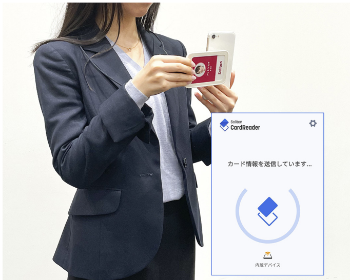
社員証など、すでに導入されているICカードを利用した認証にも対応。ICカードをスマートフォンにかざすだけでログインすることができる。
