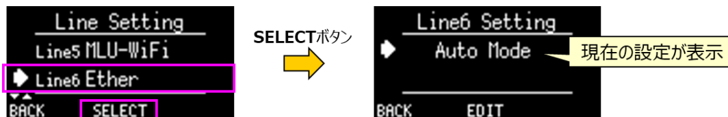
図 3-28 固定 IP 割り当て 1 (Manual Mode)
