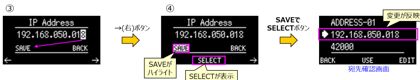
図 3-5 宛先の IP アドレス変更 3
