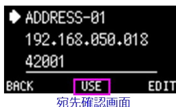
図 3-25 宛先変更 3(Direct Mode)
