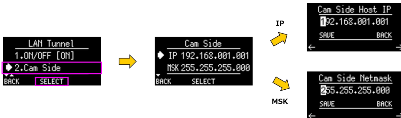
図 3-40 Cam Side(LAN Tunnel)
