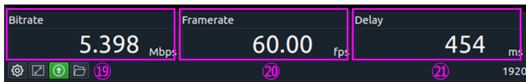
図 3-22 映像伝送ストリームのビットレート・フレームレート・遅延時間
